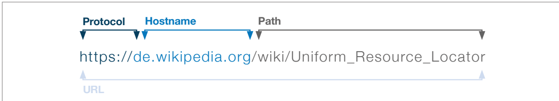
Abbildung 2: Aufbau einer URL am Beispiel von https://de.wikipedia.org/wiki/Uniform_Resource_Locator
